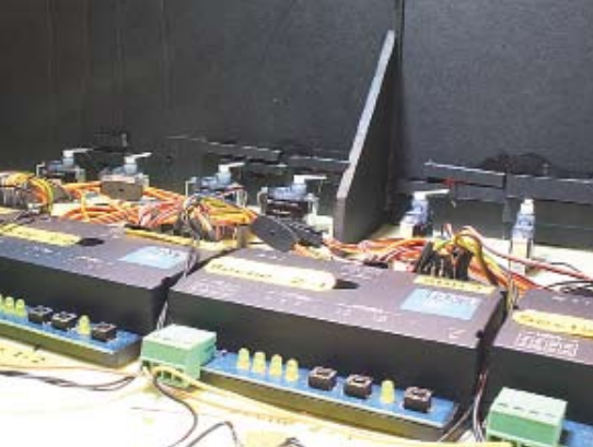
Foto 20: Dezelfde set SwitchPilots, maar dan met een betere blik op de achter de coulissen verborgen servo's.
