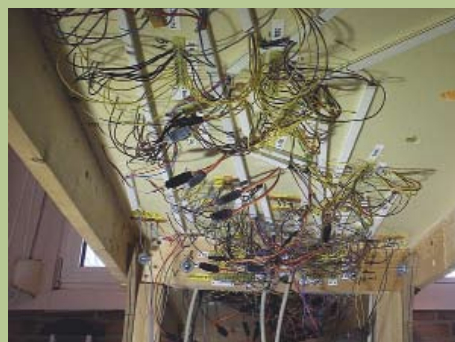
Foto 27: Onder de rechter module liggen redelijk wat draden, we zien daar ook de crossings naar de servo's aan de andere kant van het spoor
