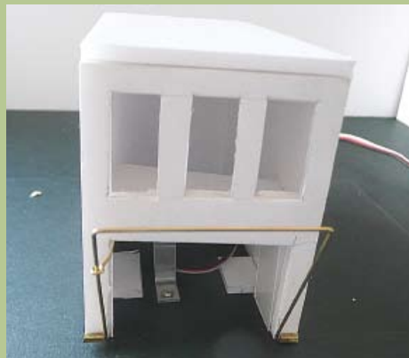
Foto 17: De voorzijde van het prototype, waarbij nog net de servo te zien is, maar ook de twee buisjes aan de voorzijde, die als scharnierpunten dienen.
