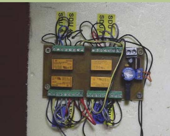
Foto 23: De door Maarten gebouwde print met 4 bi-stabiele relais en een eigen gelijkrichter.
