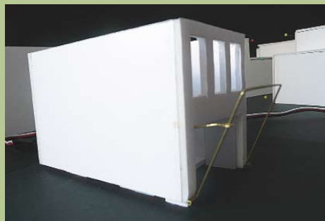
Foto 16: Het proefmodel van de woning gezien vanaf de zijkant. De luifel is iets hoger dan de onderzijde van de ramen, maar later werden de ramen van de etage een beetje omhoog getrokken, waardoor de luifel net onder de raampartij valt.
