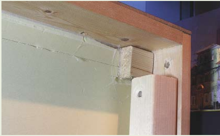
Foto 12: Een extra houten blokje in de tafel om het scharnier voor de poot vast te zetten. Tevens is goed te zien dat de Jocardur plaat in het frame van de tafel valt.
