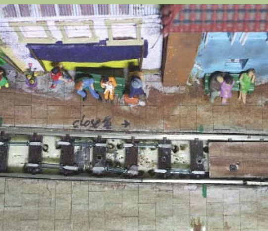
Foto 21: Een setje van 6 reedcontacten tussen de railstaven gemonteerd. U ziet op het trottoir de tekst staan close 1 met een pijltje: d.w.z. dat hier de luifels van de eerste groep weer naar beneden gaan. Dat wordt duidelijk gemaakt met foto 22
